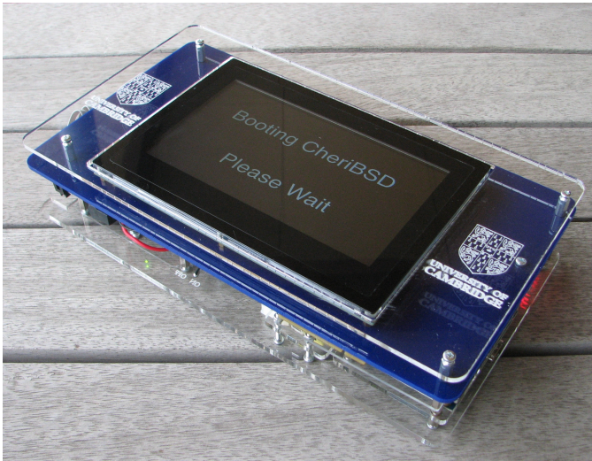
Fig. 14. BERIpad booting FreeBSD
