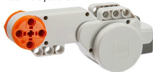
Fig.19 LEGO DC motor
